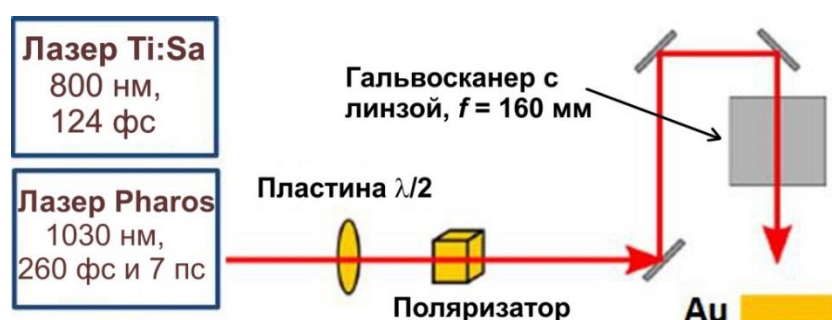
Рисунок 11. Схема эксперимента по измерению порогов модификации и абляции золота.
